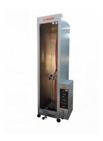
FOR TESTING RESISTANCE OF CABLES TO BURNING
